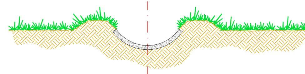
Demolizione del rivestimento in calcestruzzo dello spessore medio di 10 cm, di eventuali manufatti prefabbricati, ponticelli ed attraversamenti di qualsiasi tipo e natura esistenti lungo i canali. Il carico del materiale su automezzo idoneo, il trasporto ed il conferimento in discarica compresi gli oneri relativi. La sistemazione della sede del canale con la demolizione dei due argini e lo stendimento del materiale di risulta fino al pareggio con il piano di campagna esistente.
